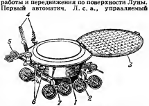
Советский лунный самоходный аппарат (Л.-1) с передвижной установкой: 1 — лунный самоходный аппарат; 2 — солнечная батарея; 3 — антенны; 4 — антенны; 5 — углольный отражатель; 6 — телевизионные камеры; 7 — блок колес.
